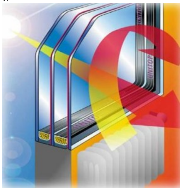
Рисунок 1 - Теплоотражающее покрытие стеклопакета
